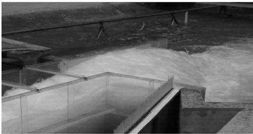
图 4 跌坎提高 3.0 m 后消力池尾坎处流态
