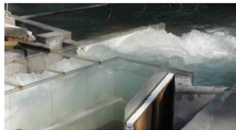
图 11 侧堰增高 0.5 m 消力池整体流态图
