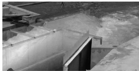
图 5 尾坎削坡后尾坎处流态
