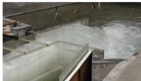
图 7 消力池末端加消能墩后尾坎处流态
